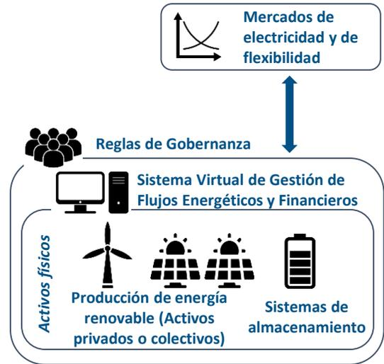
Representación esquemática de una comunidad energética industrial (Iconos de FREEPIX, diseñados por NESOI)
